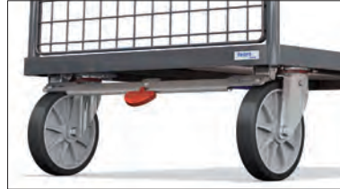
TOTALSTOP - Das fetra-Zentralbremssystem Mit nur einem Fußtritt werden Raddrehung und Schwenkbewegung beider Lenkrollen blockiert. Das Bremspedal bleibt immer im Sichtfeld des Bedieners.
