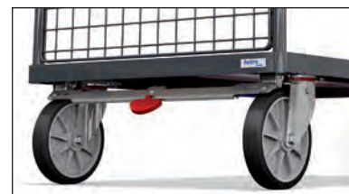
TOTALSTOP - Das fetra-Zentralbremsystem Mit nur einem Fußtritt werden Raddrehung und Schwenkbewegung beider Lenkrollen blockiert. Das Bremspedal bleibt immer im Sichtfeld des Bedieners. Serienmäßig an allen Kastenwagen.
