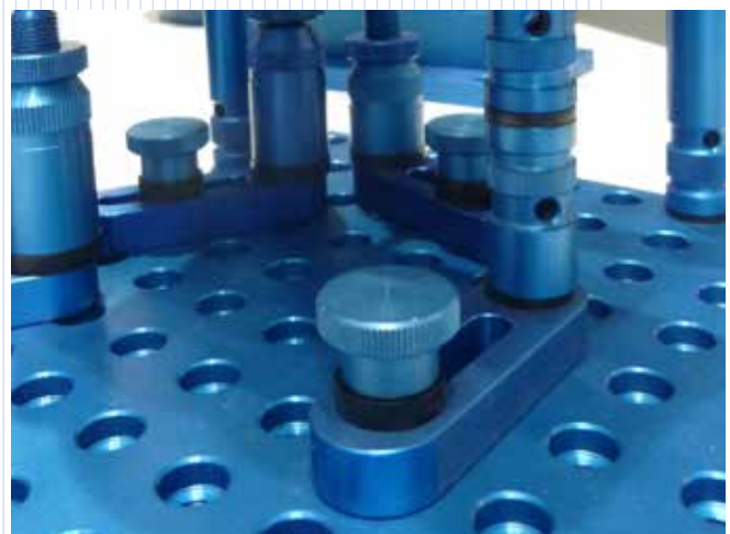
Schiebeleiste mit Rändelschraube auf Palette Slide rail with knurled screw on pallet
