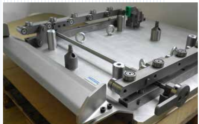
Spannstation für Koordinatenmessmaschine Clamping station for CMM
