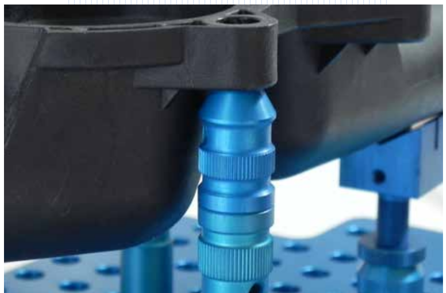
Zentrierspitze Ø16 x 33 auf Stehbolzen Center Ø16 x 33 on stud bolt
