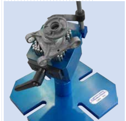
Nadelaufgabe auf Gelenk-Anschlussbolzen Pin support on swiveling connecting bolt
